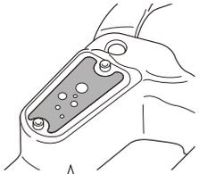
Продолжайте нажимать тормозную ручку, пока в расширительном бачке не перестанут появляться пузыри воздуха. Затем нажмите тормозную ручку до упора. В норме она должна быть при этом жесткой.
